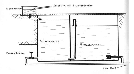
direkte Leitung in das **Reservoir**. Das Reservoir besteht aus Messkasten, wo das Wasser einfliesst, aus Feuerlöschkammer und Brauchwasserkammer. Die Feuerlöschkammer darf nur bei Brandfällen eingeschaltet werden. Damit eine ständige Zirkulation erzielt wird, gelangt das Wasser erst in die Feuerkammer, dann in die Brauchkammer und von dort aus ins Leitungsnetz des Dorfes. Das Quellwasser wird monatlich gemessen und registriert und die Qualität vom Kantonschemiker überwacht.
